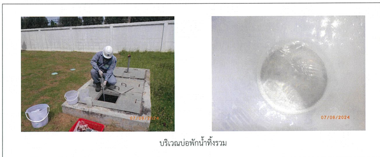
ภาพที่ 3.4.5-1 การเก็บตัวอย่างคุณภาพน้ำทิ้งจากกระบวนการผลิต
